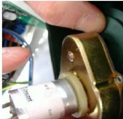
С помощью отвертки слега приподнять двигатель насоса-дозатора.
