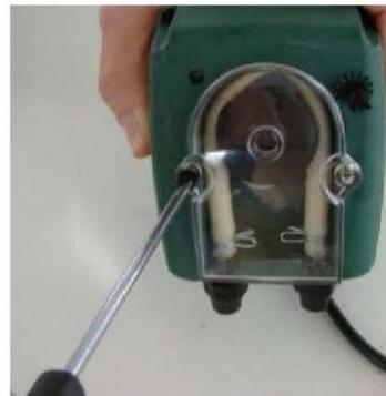
1. Отключить насос-дозатор от питания. Снять переднюю пластиковую крышку, открутив два винта.
