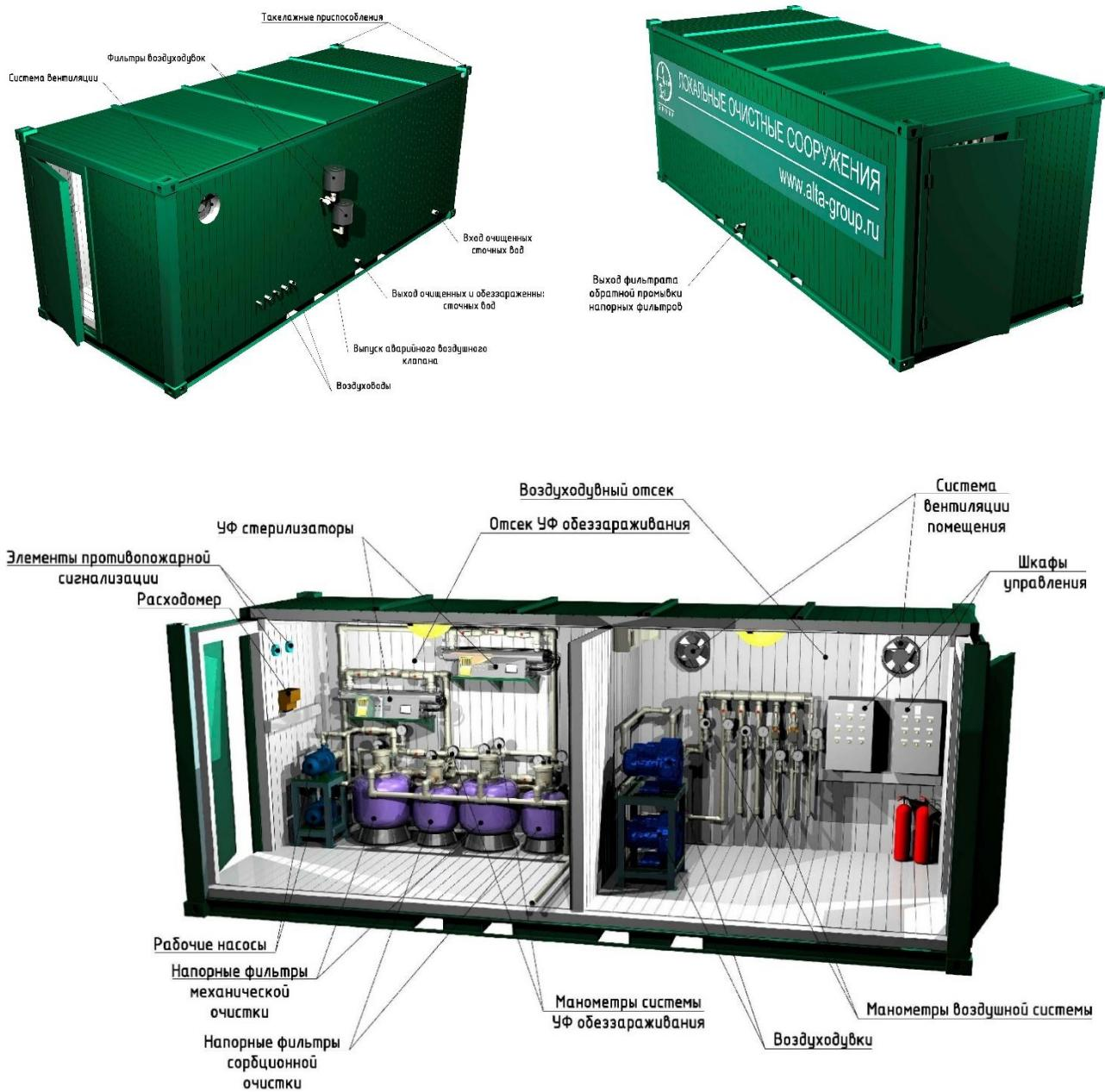
При данном исполнении в комплект поставки Блока входит сборно-подающий колодец для забора очищенной воды на обеззараживание, в данном колодце установлен комплект датчиков уровня для управления насосным оборудованием Блока, в соответствии с ТЗ и с соблюдением установленных норм и правил через данный колодец может быть организован аварийный самотечный байпас (обводная линия) Блока.
