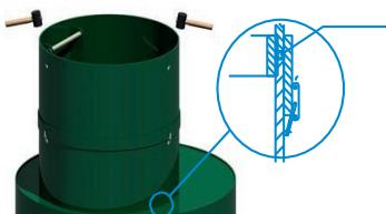
6. равномерно осадить удлинительную горловину на горловину Станции с помощью киянки;
