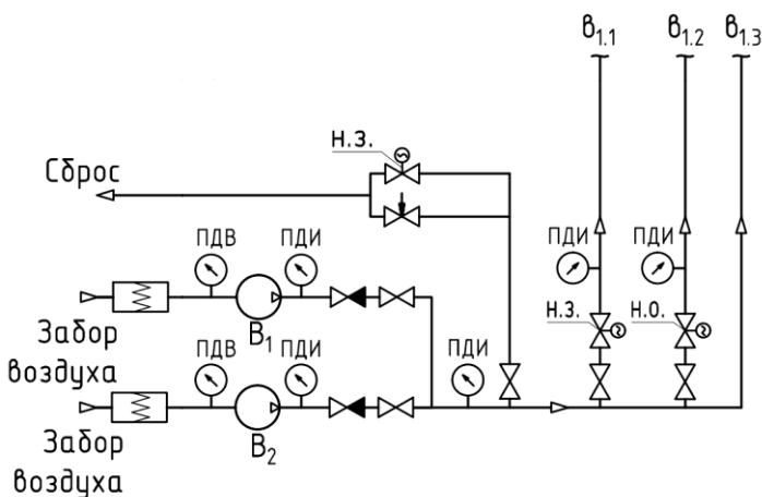
ПДВ – Преобразователь давления вакуумметрического.
