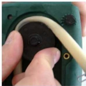
5. Продолжать вставлять перистальтический шланг между корпусом насоса и фиксатором, при этом вращающиеся ролики насоса-дозатора помогают проталкивать перистальтический шланг.
