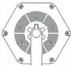
Режим (1) FILTER фильтрации, основной рабочий режим фильтра. В режиме фильтрации вода подается сверху фильтрующего материала и отводится снизу через дренажное устройство (сепараторы) на отводящий патрубок и далее на УФ стерилизатор для обеззараживания.
