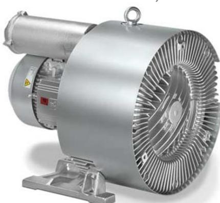
Принцип действия вихревой воздуходувки основан на многократном воздействии лопаток импеллера на рабочую среду. Газ через всасывающий патрубок поступает в межлопаточные каналы рабочего колеса. Далее под влиянием центробежных сил газ выбрасывается в рабочий
