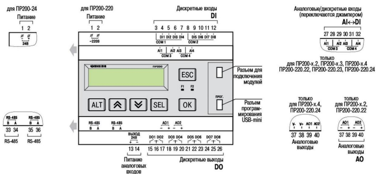
На лицевой панели прибора расположены элементы индикации и управления. Назначение кнопок управления в зависимости от режимов см. Таблица 5 текущего Раздела настоящего Паспорта.
