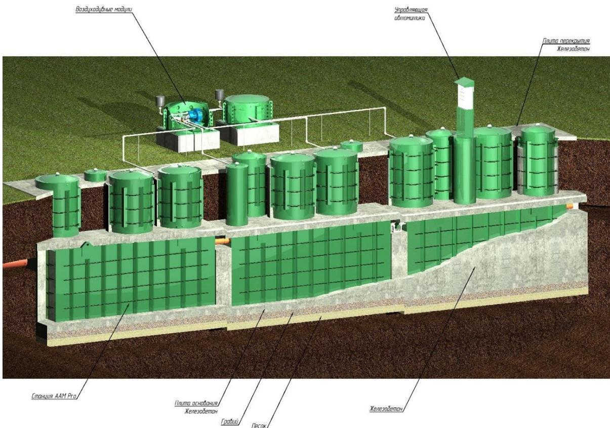
Вариант 1 монтажа Станции при значительном заглублении, с использованием удлинительных горловин рекомендован к применению при заглублении Станции до 1200 мм от уровня земли до верхнего горизонтального пластикового перекрытия Станции.
