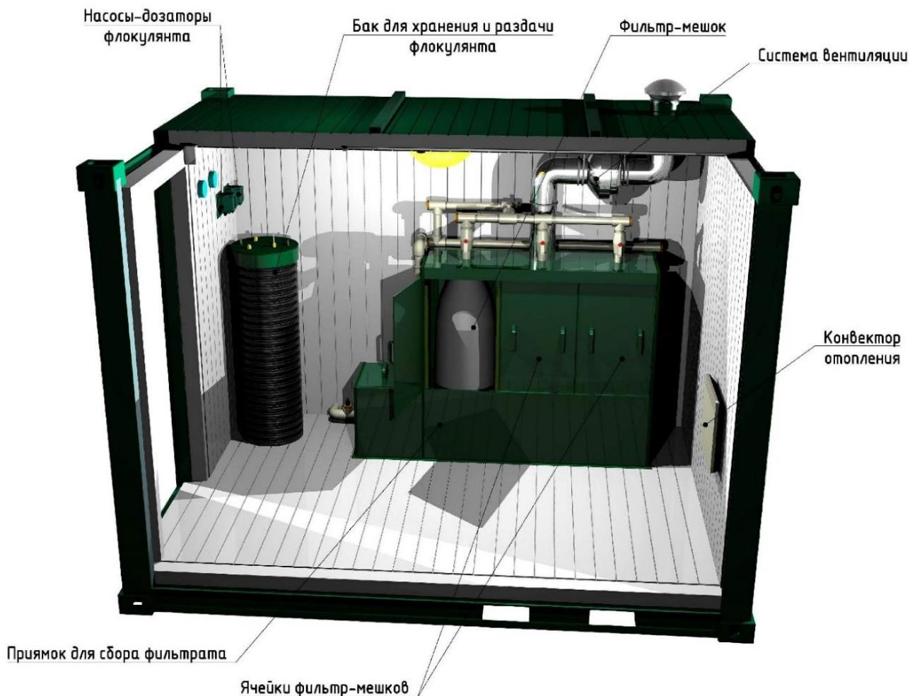
Обезвоживатель мешковый Alta Solid Trap выполнен в пластиковом корпусе, в котором установлен блок фильтрационных мешков, в нижней части корпуса организован канал-приямок для сбора фильтрата, отделенный от блока фильтрационных мешков перфорированным перекрытием, из канала организован выпуск фильтрата в самотечном режиме, при монтаже Комплекса ОС этот выпуск подключается к приемной камере Станции или в камеру подающей КНС.
