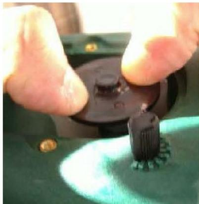
Снять двигатель насоса-дозатора.
