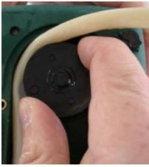
4. Протолкнуть левую часть перистальтического шланга под фиксатор, ролик должен быть перед перистальтическим шлангом, включить насос-дозатор на малую скорость вращения роликов.
