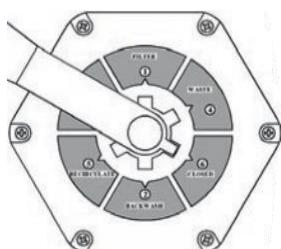
В режиме (6) CLOSED вентиль закрыт шестипозиционный вентиль закрыт. Движение жидкости через фильтр не осуществляется. Режим предназначен для обслуживания фильтра.
